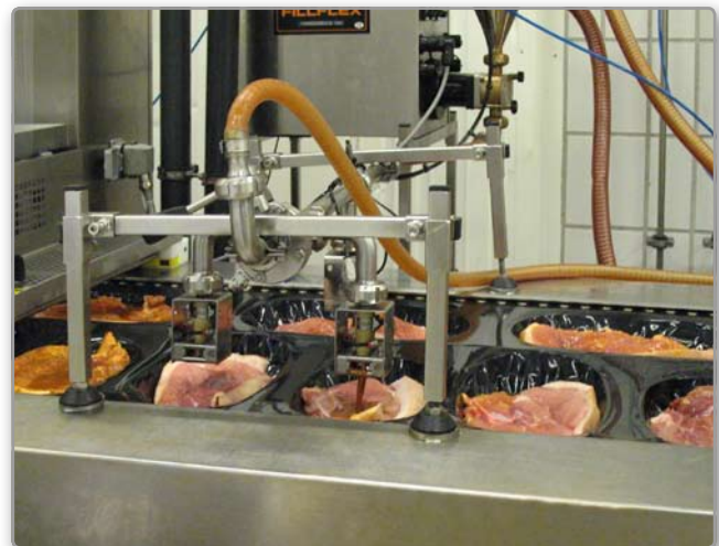
Fillflex Sequence fyllningsmaskin, med tratt och matarpump, suger marinad direkt ur en skänkvagn och doserar en exakt mängd varje gång.
