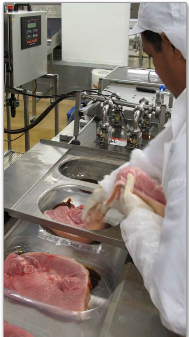
Först doserar den ena av de båda Fillflex Sequence en del av marinaden i det tomma tråget. Därefter läggs det rena köttet i för hand.
